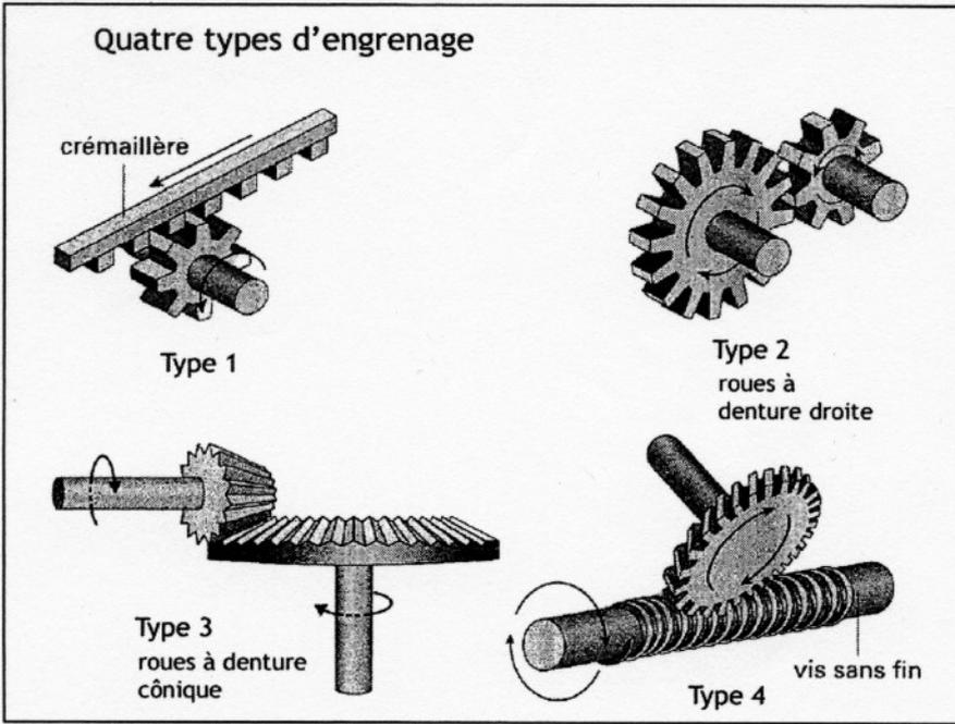
Un engrenage est un mécanisme composé de deux roues dentées mobiles autour d'axes de position relative invariable.
